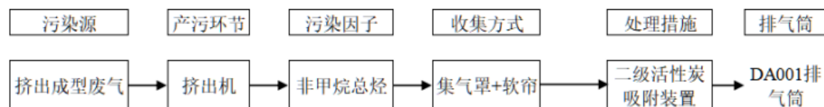
图 4-3 废气收集管线图
